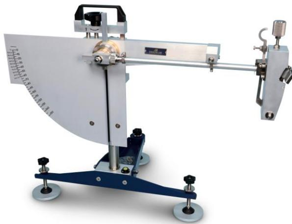
**COEFICIENTE DE RESISTENCIA AL DESLIZAMIENTO**
