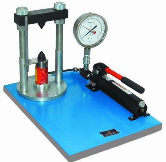
**A175** Equipo de carga puntual formado por un bastidor rígido sobre el cual se monta un marco de ensayos formado por dos columnas con puente superior regulable, pistón hidráulico accionado por una bomba manual, regla milimetrada para medir la distancia entre dos puntas cónicas construidas en acero especial, y un manómetro graduado de 400 Kg/cm<sup>2</sup>
