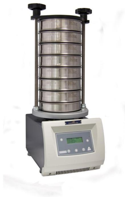
**A071** Tamizador electromagnético para tamices de Ø200 y 203 mm(8”). Indicado para tamizado de material fino. Módulo de control digital con regulación de potencia, intermitencia y tiempo de tamizado entre 1 y 999 minutos. El equipo permite realizar también ensayo de tamizado por vía húmeda. El módulo de control separada del cuerpo de la máquina para evitar salpicaduras. Sistema de sujeción de tamices mediante varilla roscada y tapa de acero.
