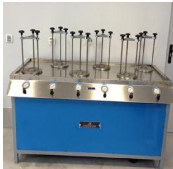
**C098** Equipo para ensayo de penetración de agua de 3 puestos.
