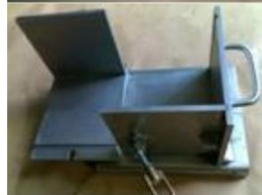
Moldes prismático de acero para preparación muestras de hormigón, interior rectificado, totalmente desmontable
