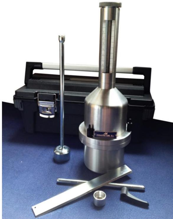
**Roll-A-Meter Método de ensayo normalizado para determinar el contenido de aire del hormigón fresco por el método volumétrico ASTM C173 / AASHTO T 196**
