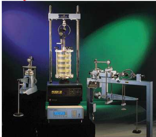
Equipo Triaxial originalmente diseñado en la universidad de Harvard
