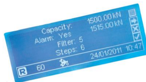
Ajuste de la alarma de carga máxima
