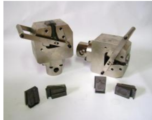
E001.04 Juego de porta-mordazas manuales. Este equipo está diseñado para poder usarse con las prensas multiensayos dependiendo de la capacidad de cada máquina. Se suministra con dos juegos de pinzas, uno plano y otro en V para redondos. Pinzas planas: para probetas planas de 0 a 10 mm de espesor Pinzas redondas: 0 a 7 mm de diámetro. Pinzas en V: para probetas redondas de 8 a 14 mm de diámetro. E016 pinzas en V para probetas redondas de 15 a 22 mm de diámetro.
