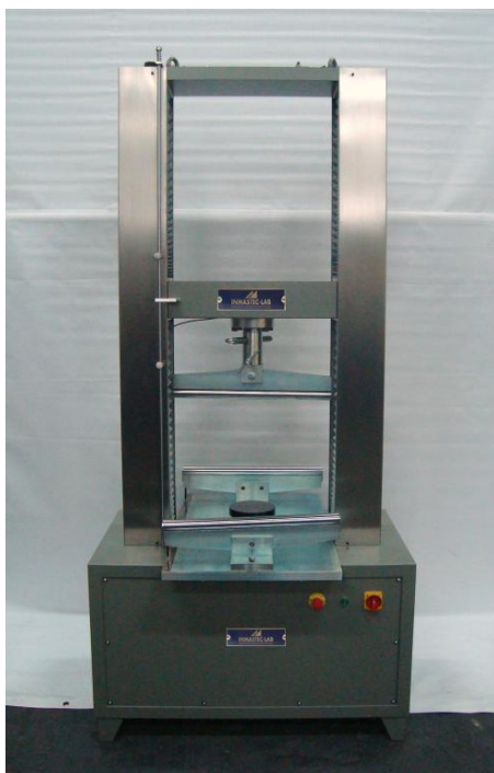
MÁQUINA UNIVERSAL DE ENSAYOS S164 Prensa electromecánica, automática y servocontrolada de doble husillo, gobernada por ordenador de última generación similar al modelo S160, pero con dispositivo de flexotracción para bordillos y baldosas, bloques planos, flexión en tejas, etc.
