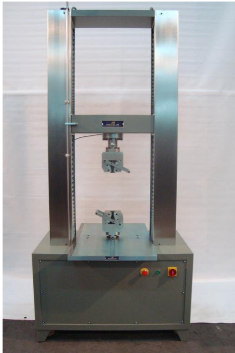
MÁQUINA UNIVERSAL DE ENSAYOS S164 Prensa electromecánica de doble husillo Máquina de ensayos automática y servocontrolada de doble husillo, gobernada por ordenador de última generación similar al modelo S160, pero con porta-mordazas para ensayos a tracción de barras de acero.
