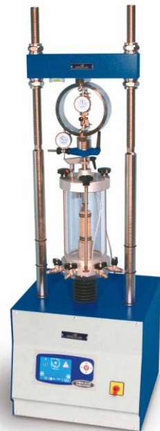
S095 con anillo dinamométrico
