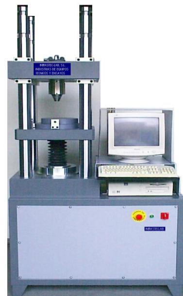
**S157.05** Calibración con emisión de certificado ENAC “in situ” para máquina de 400 KN
