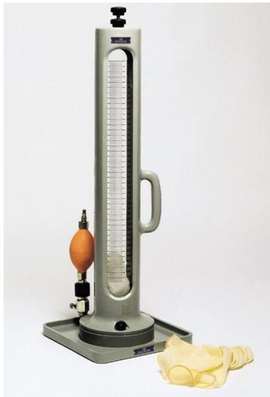
**S191** Voluminómetro de membrana de 1600 ml de capacidad.
