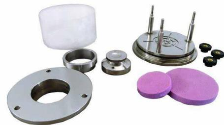
**CONSOLIDACIÓN UNIDIMENSIONAL DE UNA MUESTRA DE TERRENO SOMETIDA A UNA CARGA AXIAL QUE PERMITE EL DRENAJE POR AMBAS PARTES (SUPERIOR E INFERIOR) ENSAYO DE HINCHAMIENTO EN EDÓMETRO UNE-103.405/ ASTM D2435, D4546, D3877/ BS 1377/ AASHTO T216/ NF P94090-1, P94-091**
