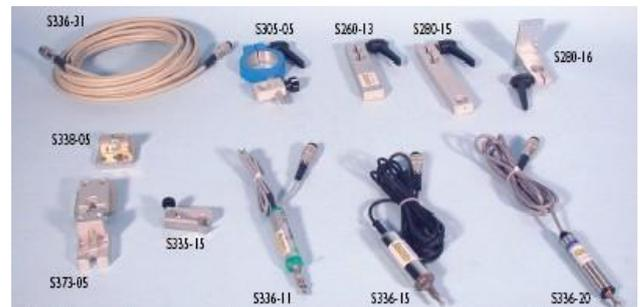
**S280.15** Dispositivo de montaje entre pinzas de sujeción S335.15 y la máquina de corte para fijar el transductor de desplazamiento vertical o el reloj comparador.
