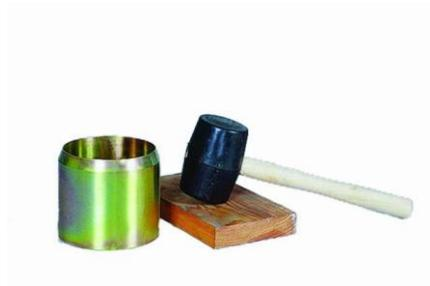
**S014** Equipo tomamuestras formado por un cilindro de filo cortante de Ø130x130 mmh. Fabricado en acero con tratamiento anti-corrosión. Se suministra completo con mazo de goma madera para golpeo.
