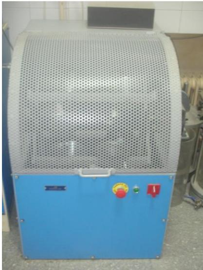
**S055** Agitador de sulfatos con capacidad para 12 frascos de 1 litro. Su sistema de sujeción de frasco es regulable y permite colocar frascos de distintos tamaños y capacidad. Se suministra completo con pantalla de protección con micro de abertura. Velocidad de rotación: 50 rpm Alimentación: 380/220V, 50 Hz. 650x600x850 mm
