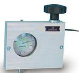
**S364.01** Dispositivo de bloqueo, mantiene en el comparador del anillo dinamométrico la carga máxima aplicada, con sucesiva puesta a cero manual. Adecuado para prensas S152 y S153
