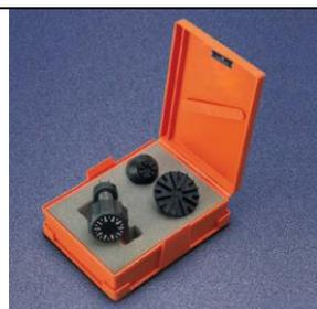
**S194** Dispositivo de molinete de mano para corte (Vane test)
