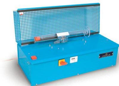
**S063** Agitador automático para ensayo equivalente de arena con una amplitud de 200 mm. de 90 ciclos en 30 segundos, con temporizador y dispositivo eléctrico de paro automático, Zeta de emergencia y pantalla de protección zona de ensayo con micro de abertura.
