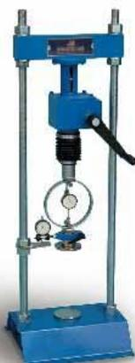
**Máquina de ensayo de compresión no confinada**
