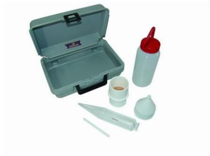
**D018** Kit de Baroid, método rápido, preciso para determinar el contenido de arena de los lodos. Consiste en un vaso de diámetro de 2,5" con tamiz de 0,075 mm que se usa como parte superior del embudo, embudo pequeño para usar y echar una muestra de 10 ml en tubo graduado. Se suministra completo con frasco lavador de 500 ml.
