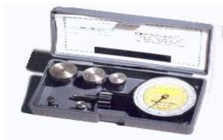
**S036** Penetrómetro de bolsillo con cuadrante, diseñado para una rápida determinación de la resistencia al corte de los suelos para cimientos, desde arcilla hasta suelos arenoso.
